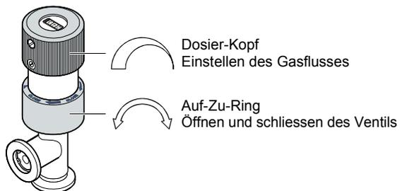
Die Drehbewegung am Dosier-Kopf wird in eine Linearbewegung umgesetzt, welche die Dosier-nadel reproduzierbar in die gewünschte Stellung bringt.
